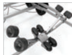
Förstärkt självjusterande vagg med kölrullar
