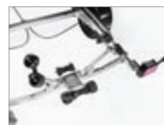
Förstärkt självjusterande vagg med kölrullar
