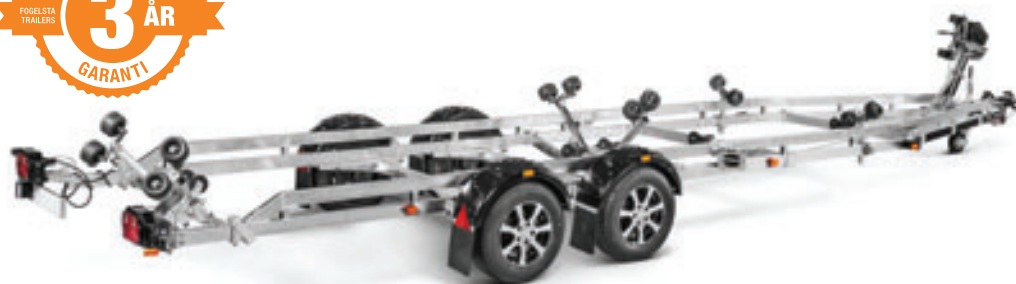
Förstärkt självjusterande vaggas med kölrullar
