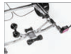
Förstärkt självjusterande vagga med kölrullar
