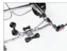
Förstärkt självjusterande vaggas med kölrullar
