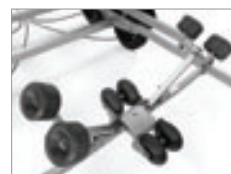
Förstärkt självjusterande vagg med kölrullar
