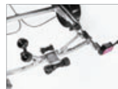
Förstärkt självjusterande vaggas med kölrullar
