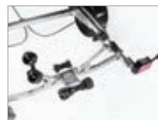
Förstärkt självjusterande vagga med kölrullar
