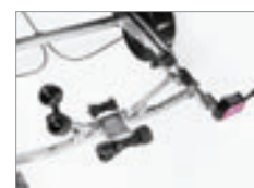
Förstärkt självjusterande vaggas med kölrullar
