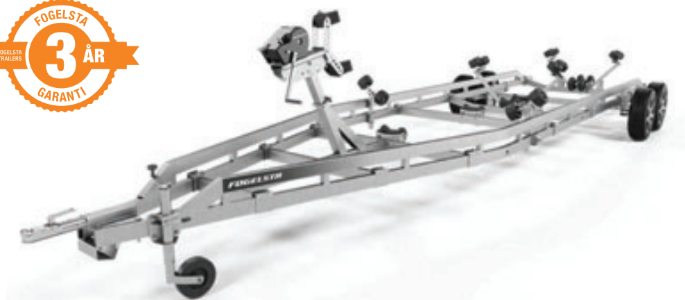
Förstärkt självjusterande vagg med kölrullar
